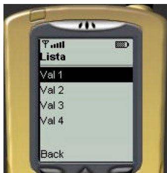
Figur 5-2: Lista som skapas med hjälp av klassen List som finns i högnivå API:et
