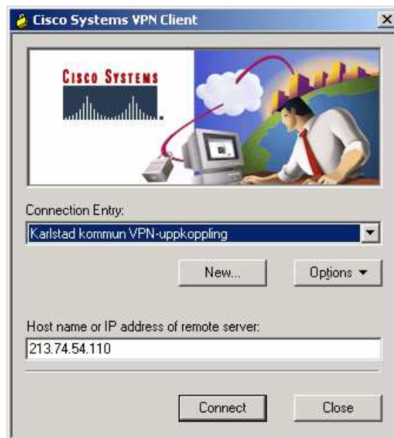
Figur 4.9: Cisco VPN Client, uppkoppling färdigkonfigurerad
