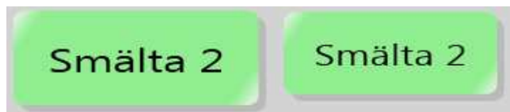
Figur 4.2 Den vänstra noden visar dess storlek när den blivit klickad på eller muspekaren hovrar över den. Noden till höger visar dess storlek i övriga fall
