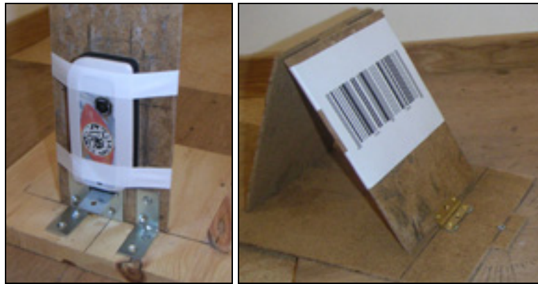
Figur 4.3 - Kamera- och streckkodsställning
